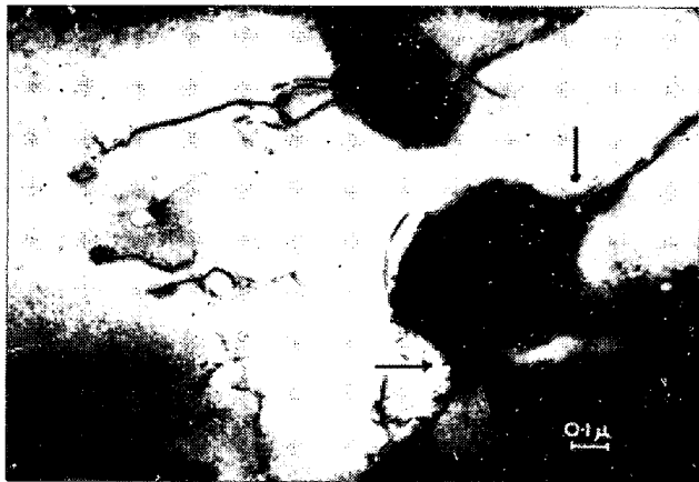
写真3 照射した AISI 316 ステンレス鋼に見られる He 気泡 (照射条件: 300°C, 1.5 \times 10^{22} \text{ n/cm}^2 > 1 \text{ MeV} )
