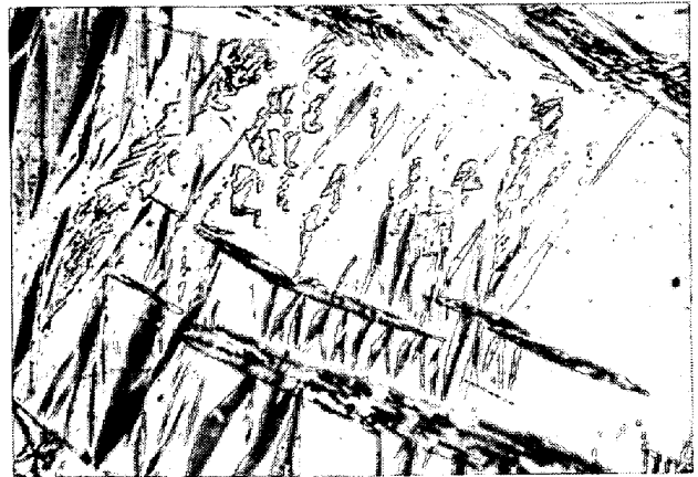
写真 5 Fe-28.7%Ni-0.26%C オーステナイトを -11^{\circ}\text{C} で 73% 引張加工し、研磨、腐食して加工誘発マルテンサイトを組織として出した後、 -60^{\circ}\text{C} に冷却して冷却マルテンサイト (オースフォームドマルテンサイト) を表面起伏として現出させた光学顕微鏡組織 \times 350
