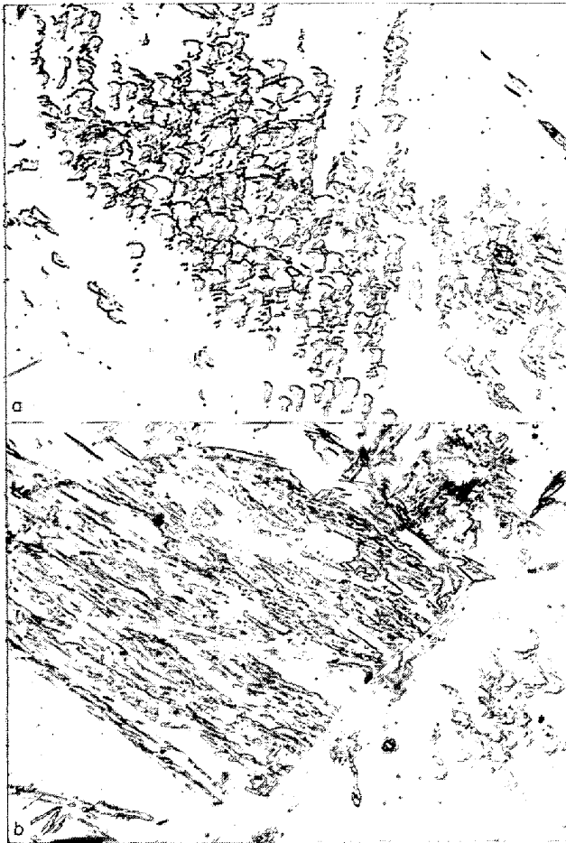
写真 3 Fe-28.7%Ni-0.26%C オーステナイトを -11^{\circ}\text{C} で 34% 引張加工したときの光学顕微鏡組織。(a)(b)は視野の相違 \times 400 (1/2)
