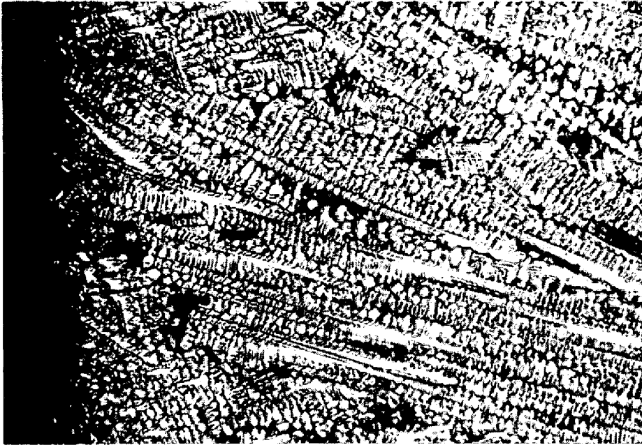
写真 11 25Cr-20Ni 遠心鑄造材のデンドライト組織 2) (鈴木) ×50 (10/13)
