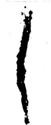
写真3. Ca快削鋼中にみられるCa介在物 (X600)
