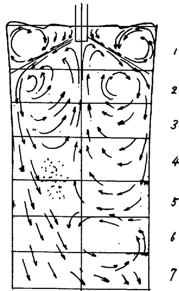
図1 エクステンションノズル鑄込の噴流口角度 \theta = 25^\circ タンデムシユヘッド H = 300 突込深さ d = 140
