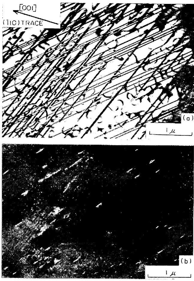
写真 11 Fe-27.8 at% Al 合金, 1000°C より 20°C/hr の冷却速度で徐冷後わずかに冷間圧延 (a) 111-暗視野像 (b) 222-暗視野像 (a) ではみられるが (b) ではみられない直線状の逆位相境界は転位の背後に残された \frac{1}{2}a_0\langle 100 \rangle 型である 30) .
