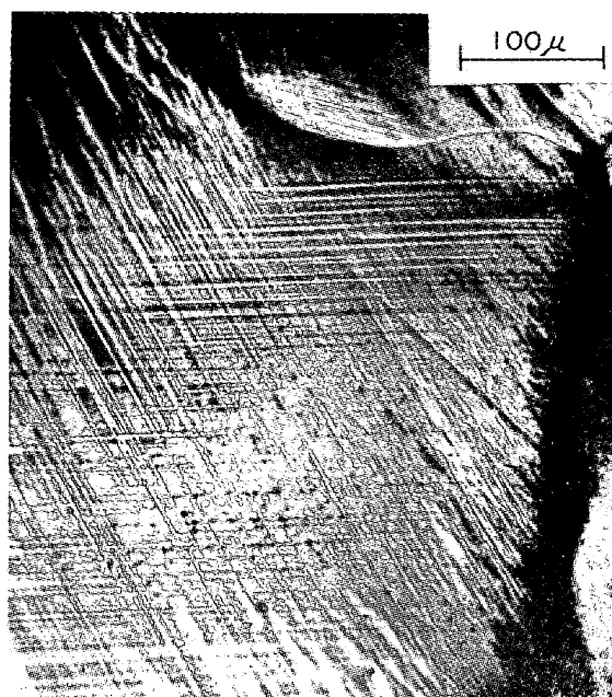
写真 9(a) 規則度 0.59 の FeCo 合金を 4.39% 塑性変形(第 II 段階)した際表面に表われたまっすぐなすべり線を示す光学顕微鏡写真 13)
