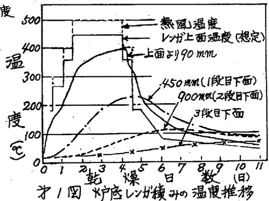
才1図 炉底レンガ積みの温度推移
