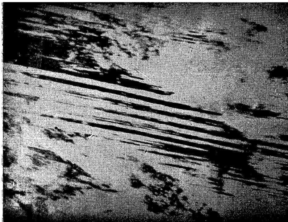
写真2 1%炭素鋼のマルテンサイト, 細かい双晶に注意 ×30,000 (3/5) (KELLY and NUTTING)
