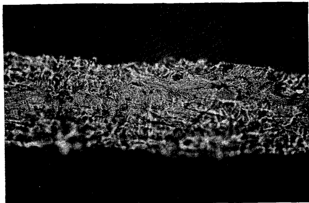
写真35 \delta フェライト(18-8ステンレス)電解抽出残渣. ×500 (4/5)
