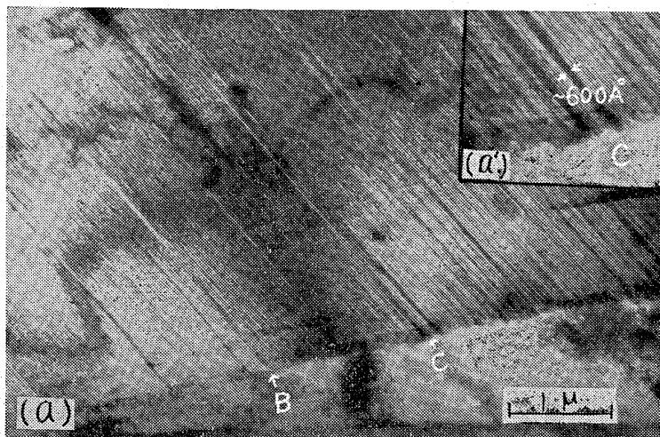
写真6 Fe-27.6%Ni-0.44%Cマルテンサイトの加工による変態双晶の消滅 (Detwinning) を示す. 透過電子顕微鏡組織 73 , (a') はC部の拡大写真で, 変態双晶の巾が約600Åに広がっていることを示す.
