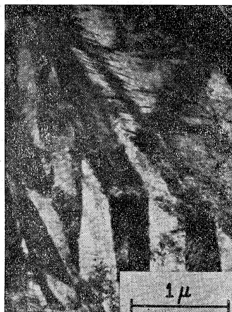
写真7 -195°Cで270kbarの衝撃荷重を与へたFe-23%Ni-0.6% C マルテンサイトの透過電子顕微鏡組織 12)
