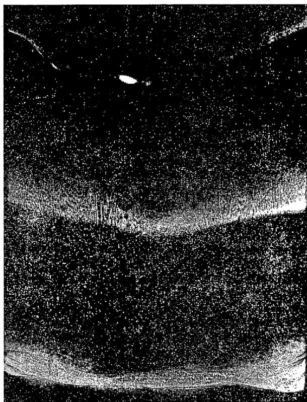
写真1 100 kg 鋼塊縦断面のオートラジオグラフ (プールの形を示す) ×1/3
