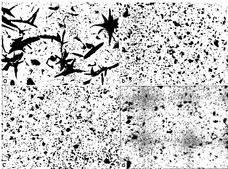
a) As cast b) 900°C, 10 min W. Q. c) 900°C 30 min W. Q. d) 900°C, 30 min. A. C.
