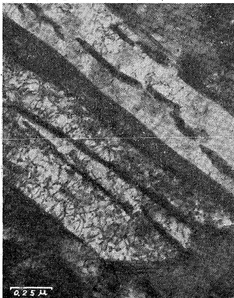
写真25 0.7%炭素鋼を 450°C 20min間恒温保持したときの上部ベイナイト組織
