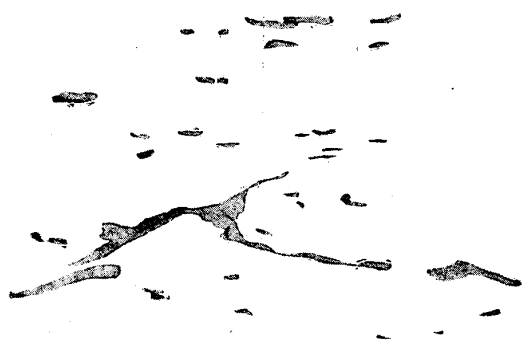
刃部炭素多き箇所にある大形の鐵滓 ×150. Silicate のみより成る 中央境界線に沿へる大形鐵滓 Silicate 中に Oxide の結晶 出つ
