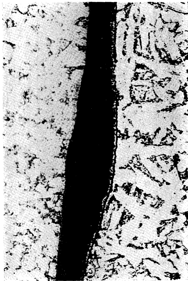
第二十五圖 五十五號刀 三百三十倍大 刃部に於ける粒狀パーライトと鐵滓
