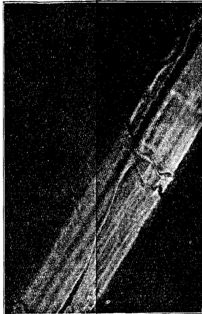
トリウム〇・七五%含有の直径〇、〇〇三六吋なるタンゲステン線、攝氏二九〇〇度に於て十分間露出せるもの。
