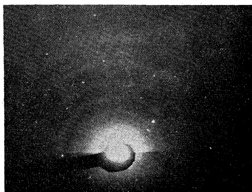
Photo. 3. 非金属介在物の電子廻折像
