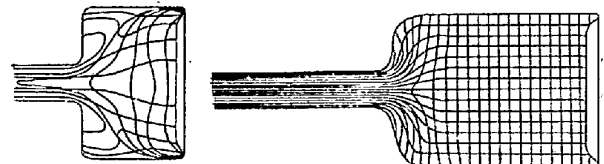
第22図 従来の押出法における金属の流れ
