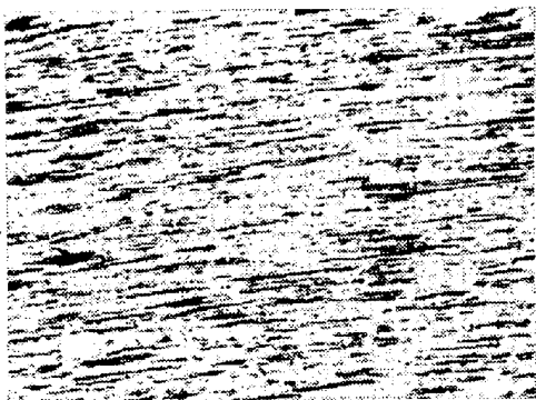
第8図 伸線した信号用燃線軟鋼ワイヤー縦断顕微鏡組織
