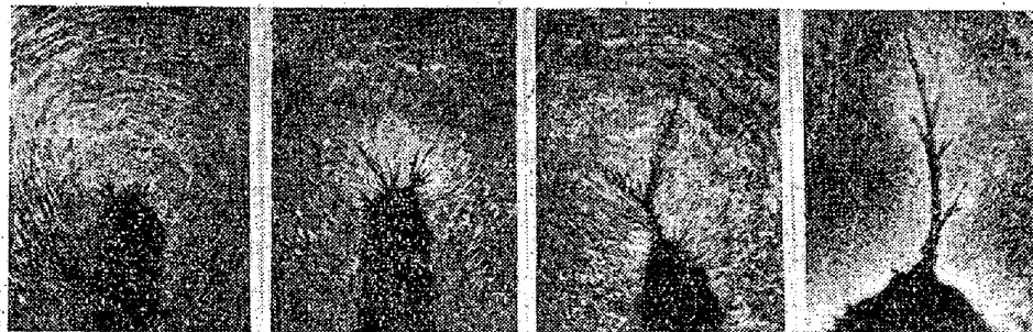
第9圖 試験片の厚みによる発生疵の長さの變化状態 (Ni-Cr-Mo 鋼の場合) ×30 (約 8/5 縮寫)
