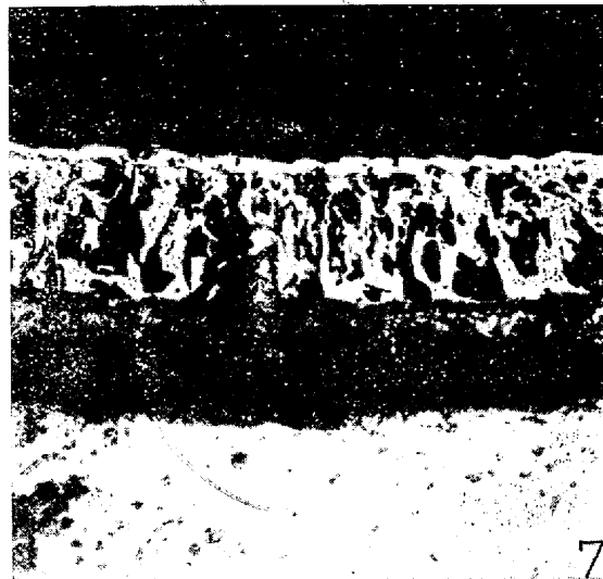
第7圖 第6圖のものと同一条件にて高温酸化せし場合に、剝離した部分の酸化物被覆断面(×100)
