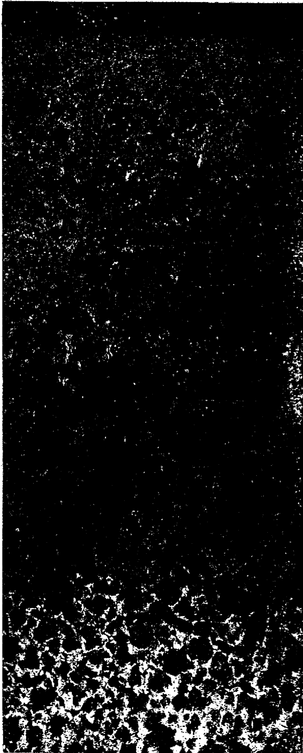
第30圖 滲炭層の組織 900°C 滲炭途中除令 2A-2 10h 滲炭
