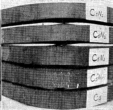
寫眞 2~7 (B) 低ニッケル含銅鋼の屈曲部に於ける割疵の發生狀況 (冷間屈曲) 鍛鍊加熱溫度 1,200°C
