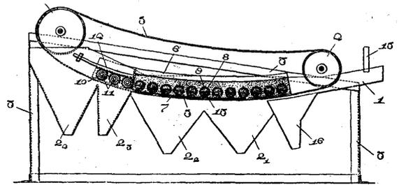
永久磁石の磁力とを以て礦物の選別を行ふ選鑛機に裝備せる永久磁石を其の廻動に對して非對照的な形態となし之を各個に又は其の數個宛適度に廻動し得る如く構成した磁力選鑛機に係る。
