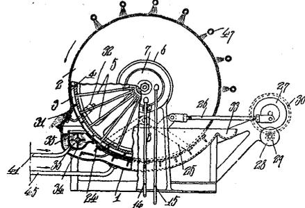
國松安治良) 本發明は圖に示す如く眞空式吸引濾過機に於ける原濾過液貯槽内の一側に於て濾過面の最初に液中に浸る部分に沿ひ特殊の液室を設け之に貯槽内の
