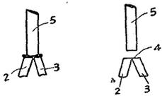
2本以上の線材の断面を並べて一の平面部となし該線材に熔接機電極の一方を接續し別に準備せる熔接用補助線材を電極の他方に接續し該熔接用線材の端面を前記の如く並べたる2本以上の線材の平面
