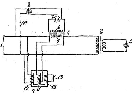
誘起電壓を以て前記直列變壓器を電源電壓と逆方向に勵磁すべくなした電氣抵抗熔接装置に係るもので非熔接時に熔接端子電壓を零ならしめ以て該端子間に於ける短絡電流を完全に遮斷し熔接時には電源電壓に近き電壓を熔接用變壓器に供給する如く構成せり。
