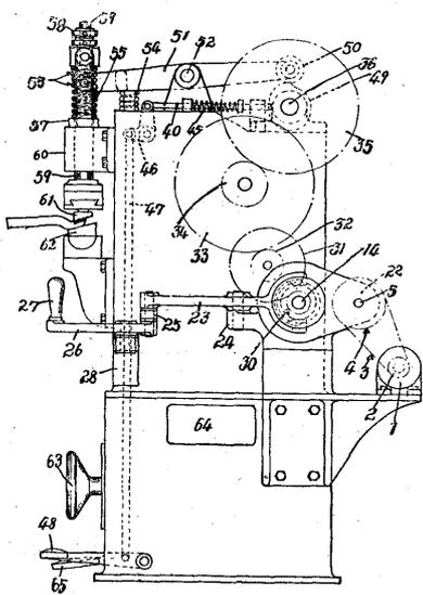
(1)の軸より廻轉せらるる被動軸(5)より減速機(22)内の齒輪列を經て減速軸(14)を廻轉すべくし同軸(14)上の齒輪(30)より傳動齒輪を經てカム軸(36)を廻轉せしめ之に定着せるクラッチ(39)と軸(37)に摺動すべく嵌合せるクラッチ(40)との齧合によりカム(49)を間歇的に廻動すべくなし尙カム(49)の作動を受くる擺動レバー(51)の一端を加壓杆(59)に關着し該加壓杆が被熔接片に達すると同時にクラッチ(39)(40)の齧合を外づしカム(49)の廻動を停止し被熔接片を加壓杆上の彈機(55)にて押壓せしめ次に電極(61)(62)に通ずる電流にて被熔接片が熔融状態に達したる時カム(49)に急廻轉を及すべき減速機(22)の變換レバー(23)を具へしめ且熔接を終り加壓杆の上昇終點に達したる時前記クラッチ(39)(40)の齧合を自動的に離脱しカム(49)の廻動を停止すべき至溝(43)とピン(44)との嵌脱機構を具備せしめた熔接機に於ける熔接部加壓装置に係る。
