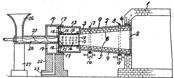
狹小にし他方を擴大ならしめた回轉圓筒の擴大部分を爐の開放口に裝嵌し他方狹小部分に接着して第 1 通風筒を設け該通風筒内に周圍に多數の小孔を穿ちたる鐵板製圓筒を挿嵌し其の第 1 通風筒を回動し得べく挿嵌部に挿嵌し此の挿嵌部に隣接して第 2 通風筒を設け該通風筒に定着して内部にスクリーンを裝置したスクリーン筒を設け其の末端に漏斗を裝着した微粉炭の燃燒装置に係る。
