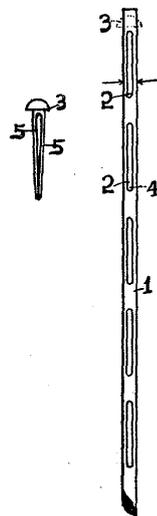
**割脚鉸製造法** (14年特許出願公告第 5339 號, 公告 14-10-25, 大阪市, 牧芳雄) 本發明は圖示する如く針金に均等間隔にして且兩側を同副とし其の中央部に長方形の縦孔を順次貫設しつつ該孔を定規として針金を週時的斷續して移送し縦孔の前端を締持し針金の切斷面を敲き鉸頭を形成すると同時に縦孔を相方より挾締壓縮し其後端より切斷して閉脚せる割脚を鉸頭と共に工作する工程を順次連續施行する割脚鉸製造法に係る。
