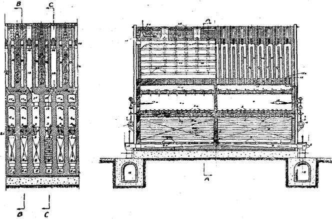
爐廓の各 2 個の狹隘室狀乾溜室を其の間に介在する加熱壁に依り一側に於て加熱し此の場合に發生する乾溜ガスを同様に他の一側に於て而もコークス化流の方向に於て強制的に最短行程を通して各 2 個の爐室間に介在するガス路壁内に吸出する様構成した乾溜装置に係るもので水平室爐に於て加熱壁を必要なる程度に低温に保持し乾溜ガスの分解を惹起せしめざる如く操作し得るものである。
