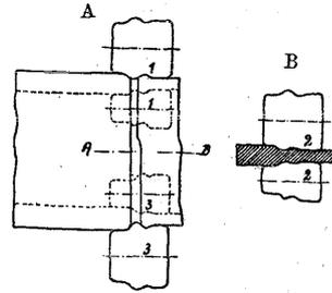
發明は圖面に示す如く突條を備へたるコロの數組を其の各の軸が中空素材の軸線に對し傾斜する様螺旋狀に配置して之等コロにより素材を順次に軸方向に伸長せしむる様なした管壓延機に於てコロ自身を其軸線方向に偏倚し得べくなし以て素
