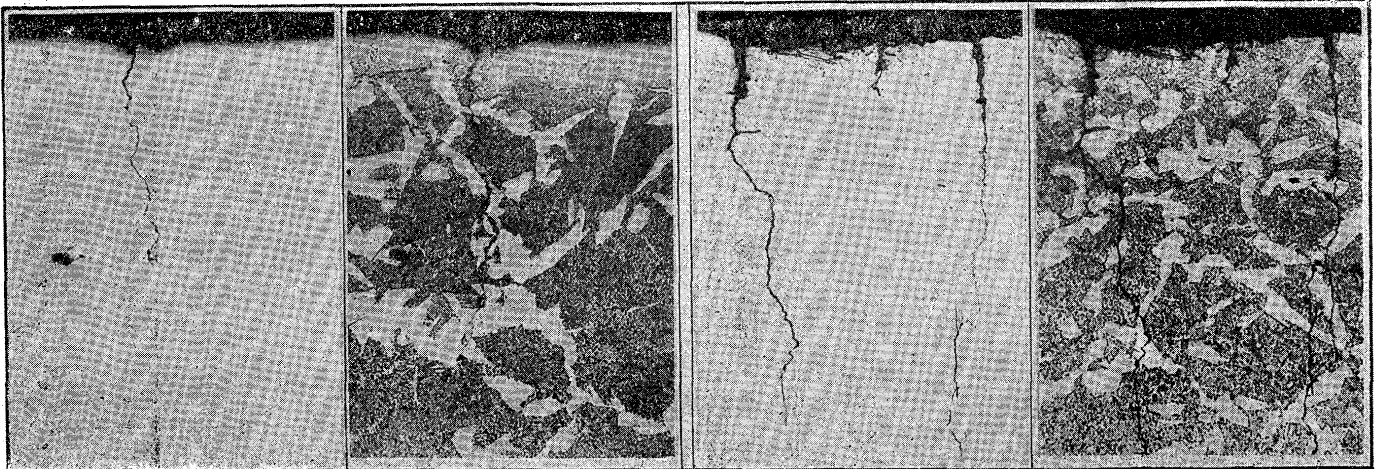
第 44 表 當所製炭素鋼ピストン棒の腐蝕疲労試験結果
