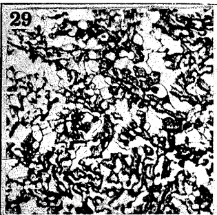
29 T 38 (89.62% Cu, 7.47% Si) 600°C より焼入 \gamma_t + X + \alpha \times 100 .
