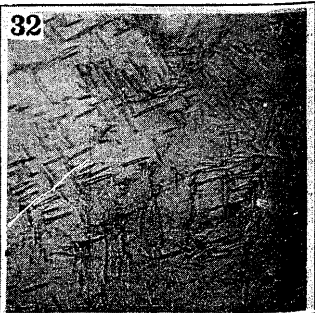
32 T 48 (88.30% Cu, 7.63% Si) 600°C より水中焼入 X + \gamma_t \times 100 .
