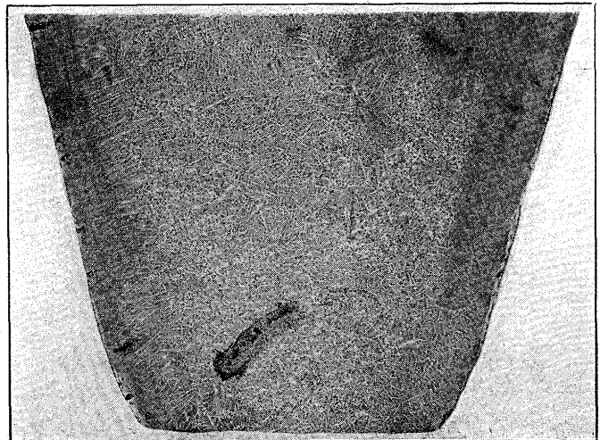
第 9 圖 鑄造鋼塊内の白點 ×1 を 0.65 に縮寫
