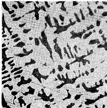
A 48 (Ni 40% Cr 48% Fe 12%) 爐中冷却 ×100
