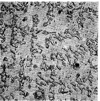
D 32 \begin{pmatrix} Ni & 20\% \\ Cr & 32\% \\ Fe & 48\% \end{pmatrix} \times 50
