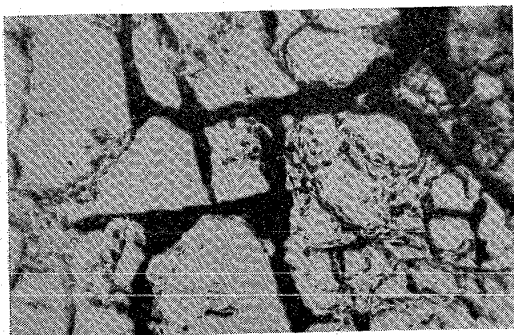
寫眞 No. 12 焙燒厚板滓(B) ×50 白色—酸化鐵 黑色—空洞 (焙燒の爲結晶境界に生ぜしもの)
