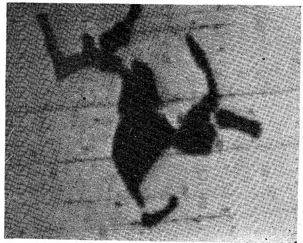
炭素鋼 0.1%C. 640°より急冷、フェ ライト地にセメントタイト ×約 2920
