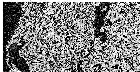
第109圖 熔接部(第4管) ×100
