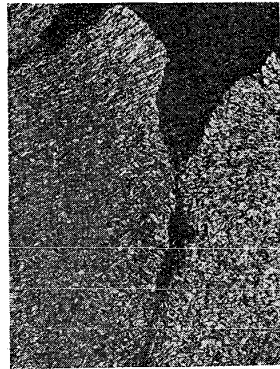
第 29 圖 鉸頭の龜裂の部分 × 25
