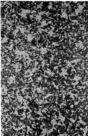
No. 3 No. 1. と同一試料 1,000°C より空中冷却 ×400
