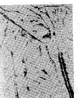
Fig 145. 4.3% C の電解鐵に硅素 2.0%を加へたるもの徐冷
