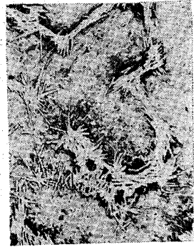
Fig. 178. 電氣爐鉄 No. 5 に Ni 2.0% を加へしもの徐冷
