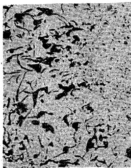
Fig. 166. 電氣爐鉄 No. 1 に Ni 0.5% を加へしもの徐冷
