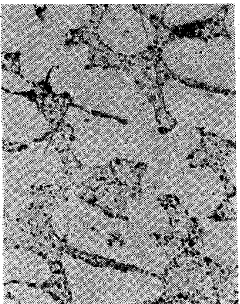
Fig 113. 電氣爐銑 No.3. 徐冷
