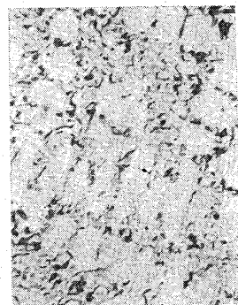
Fig 133. 電氣爐銑 No. 4 に硅素 3.0 % 含有せるもの徐冷
