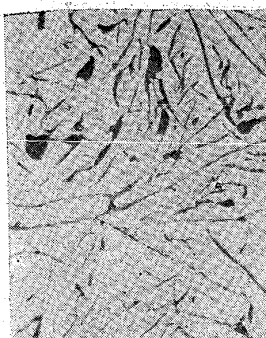
Fig 198. Fig 197. を乾燥砂型に鑄込みたる部分の中心部
