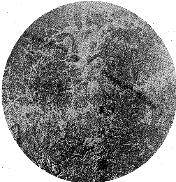
ピクリン酸腐蝕 T.C 2.96% Si 0.12% \times 100 \times \frac{2}{3}
