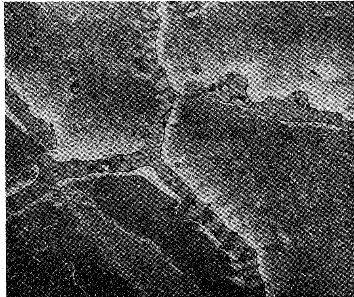
寫眞 No. 2 93 倍 ピクリン酸腐蝕 T.C 0.17%
