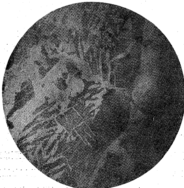
ピクリン酸腐蝕 T.C 0.19% ×100× \frac{2}{3}
