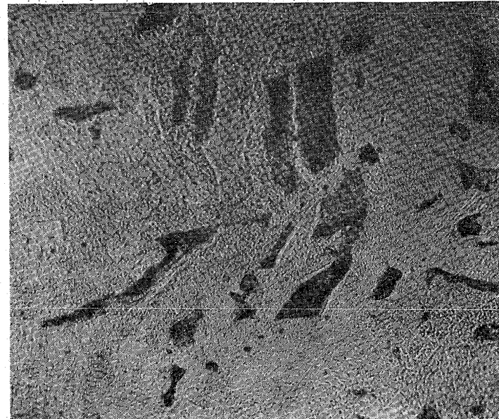
寫眞 No. 3 93 倍 ピクリン酸腐蝕 T.C 0.30%
