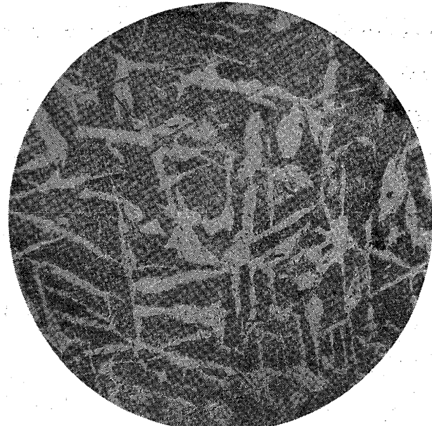
ピクリン酸腐蝕 T.C 0.27% \times 100 \times \frac{1}{2}
