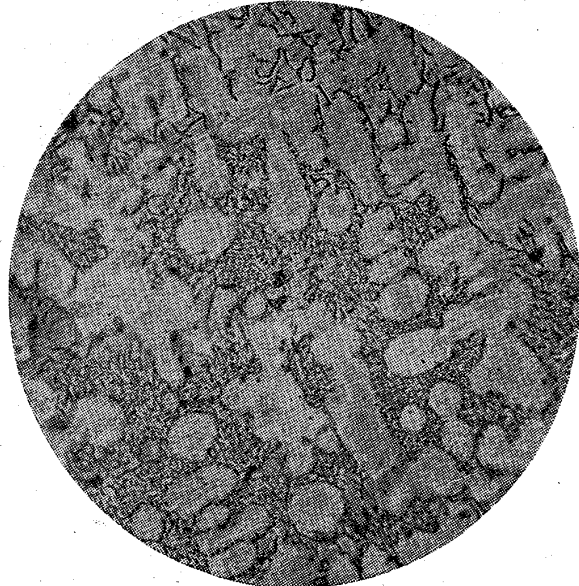
Etching by Picric acid 直径 1/2" 長さ12" 試料 抗張力 2,814 kg/cm 2 硬度(ブリネル)218
