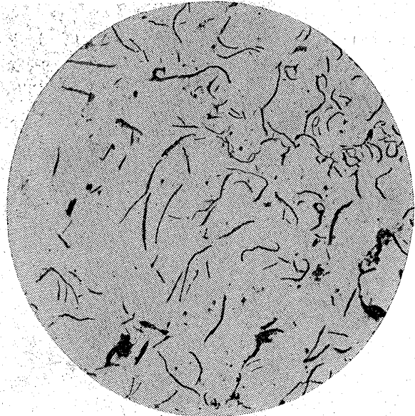
No Etching T.C Si Mn P S 2.60 3.15 1.79 0.081 0.076
