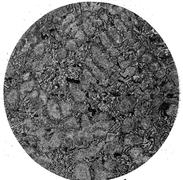
Etching by Picric acid 直径 1/2" 長さ12" 試料 抗張力 1,840 kg/cm 2 硬度(シヨアー)220
