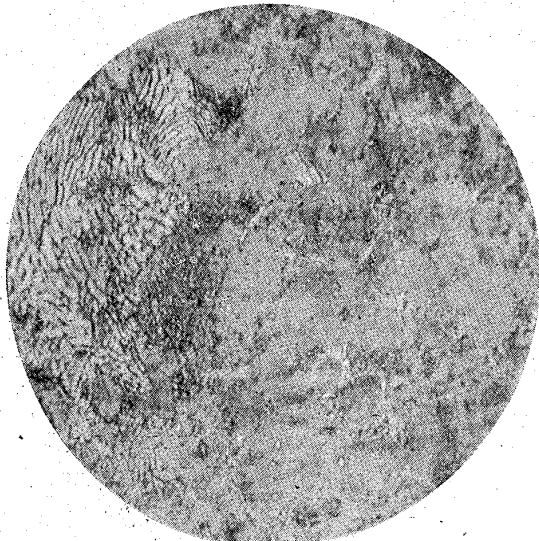
No. 3. 2.85% Cr, 0.86% C, 900° より爐中冷却 ×800 (C + P)
