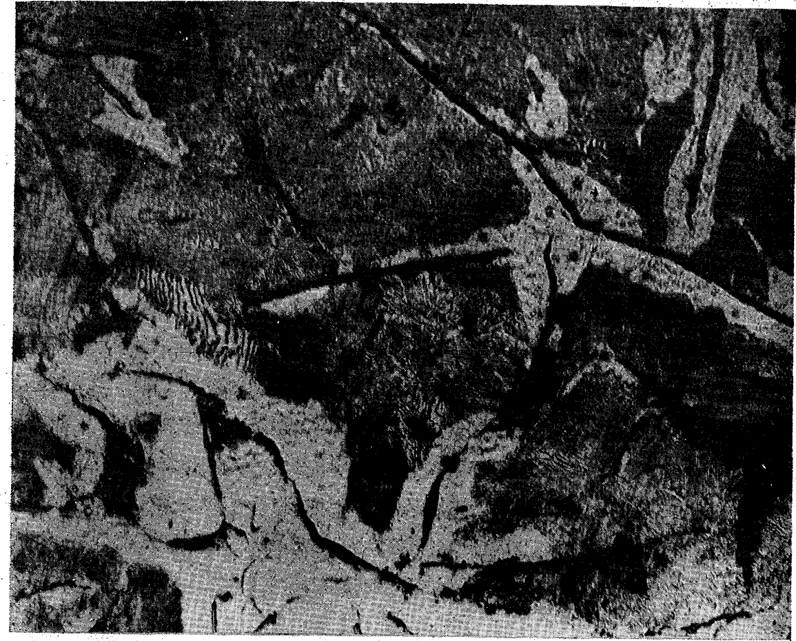
寫眞 18 { C 3.52 50 { Si 2.58 50 灰を熱砂型(457°C)中に冷却 × 400 硝酸にて腐蝕
