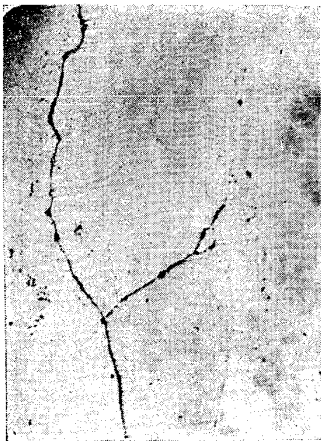
Photo. 85 Ni. 50% 1180°, 2h; Q. 1070°, 1h, Q. Al. 27% Cu. 43% 100 × \frac{2}{3} 倍
